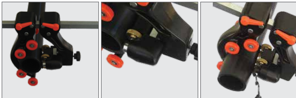
Esempio di Raschiatura Tubo D63 mm SDR11 S5 PE100 - Scraping example on pipe D63 mm SDR11 S5 PE100
