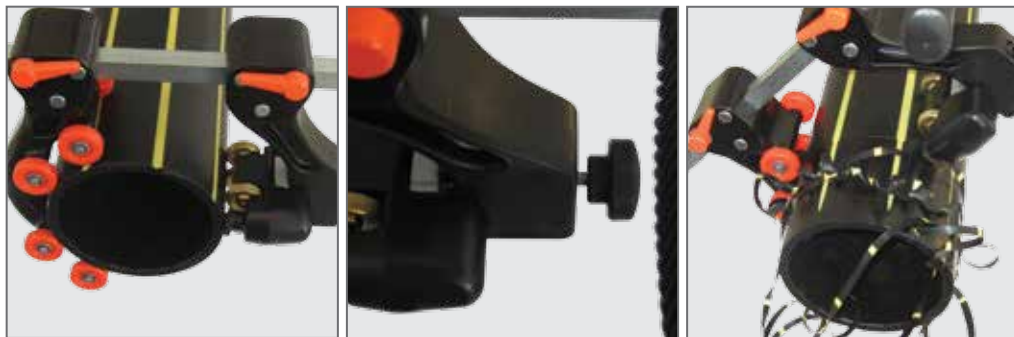
Esempio di Raschiatura Tubo D125 mm SDR17 S8 - Scraping example on pipe D125 mm SDR17 S8
